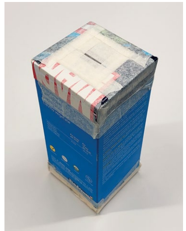
Selbstgebautes Spektrometer: einfallendes Licht wird durch einen Spalt aus zwei Rasierklingen gerichtet (kollimiert) und durch eine CD als Beugungsgitter am anderen Ende spektral zerlegt. In Abhängigkeit des Ablenkungswinkels bestimmen die Studierenden die Wellenlängen des Lichts verschiedener Quellen.
